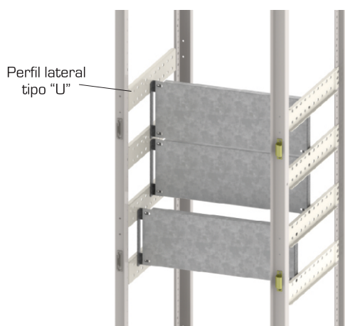
Placa de montagem segmentada fixada diretamente nos perfis laterais
